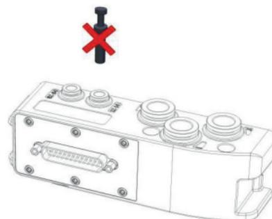
**Fase 2.** Eliminare il tappo e collegare il tubo di alimentazione sulla connessione 12-14
