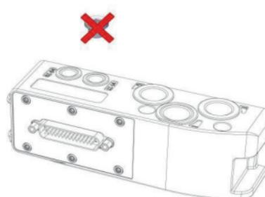
**Fase 1.** Eliminare il tappo, montare il raccordo e collegare il tubo di alimentazione sulla connessione 12-14.
